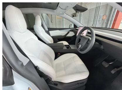
スタートスイッチもシフトスイッチさえも見当たらない、モデルYの“ミニマム”なコックピット
