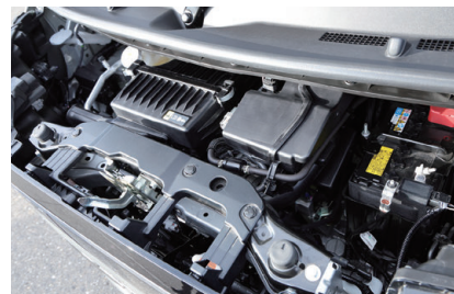
最高出力38kW/6400rpm、最大トルク60Nm/3200rpmを発揮するNAエンジン。低中速での自然な加速で扱いやすい設定
