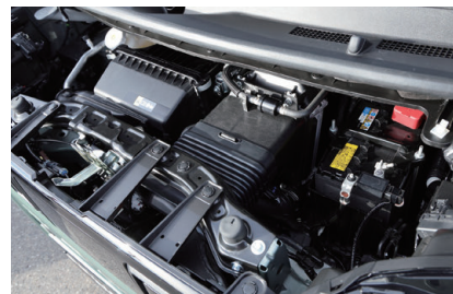
最高出力47kW/5600rpm、100Nm/2400～4000rpmを発揮するターボエンジン。アウトドアを楽しむデリカミニにぴったり
