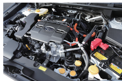
2.5ℓ水平対向4気筒エンジンを中心に、できるだけ左右対称にレイアウトされたエンジンルーム
