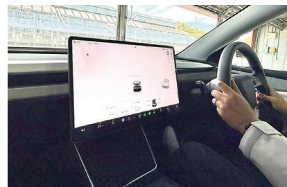
シフトも、大型センターディスプレイ画面右上に投影されたものを上下にスワイプして、前・後進を選ぶ
