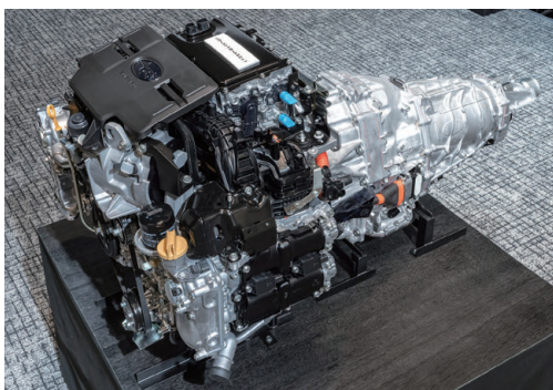
ストロングハイブリッド・ユニット。小型化されたPCUを水平対向エンジンの上に置く
