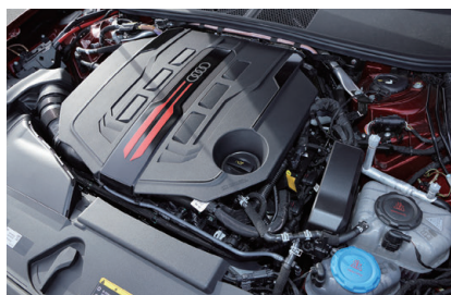
エンジンはディーゼルトーボを含む3種に、いずれも48Vマイルドハイブリッドの組み合わせ
